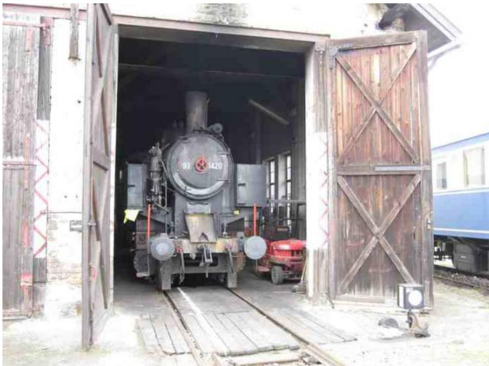
An der 93 wurden gerade die Überhitzerrohre erneuert. Immerhin soll sie am Ostermontag für eine Osterausfahrt bereit stehen. Zur Bekohlung schleppte der Obmann mit einer 2060 die alte Dame aus der Halle. Ein Lastwagen Kran füllte den Tender mit fast 4 Tonnen Steinkohle. Zurück in der Halle wurde an den Überhitzerrohren weiter gearbeitet.
